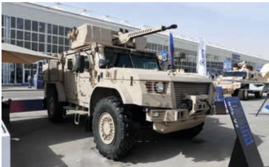
Модульная бронезащита «Титана» может меняться по требованию заказчика – дополнительно устанавливаются бронированные или сетчатые (решетчатые) экраны (фото: Юрий Ласкин)
